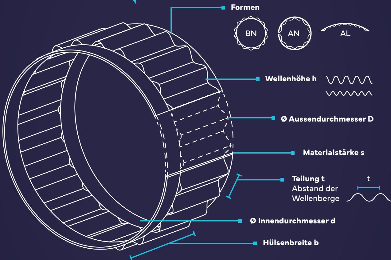
Bei Dr. TRETTER entwickeln wir für jedes Projekt schnell, präzise und wirtschaftlich die passende Lösung. Unsere Toleranzhülsen ermöglichen spielfreie, formschlüssige Verbindungen ohne aufwändige Nachbearbeitung. Ob Zahnräder, Riemenscheiben, Lüfter oder Sensorik – unsere Toleranzhülsen sind einfach zu (de)montieren, sorgen für festen Sitz, gleichen Fertigungstoleranzen und Temperaturschwankungen aus.
