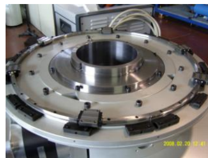
Rundschalttisch Ø 900mm, Last 2500Kg, Genauigkeit ± 0,002mm
