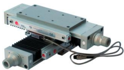
Lineartische manuell mit Trapezspindel und optisches Messsystem Genauigkeit 0,001mm
